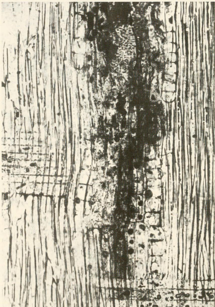
Abb. 9: Radialschliff. Unseptierte Libriformfasern und einige Kristallkammer-Schläuche.
