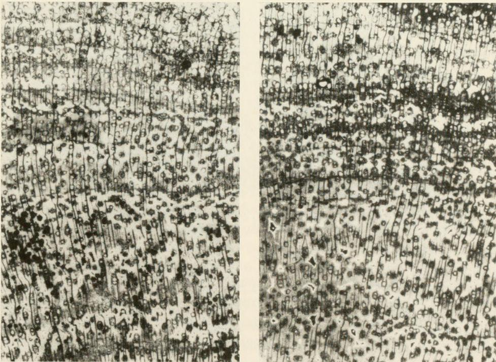
Abb. 2: Querschliffe. Zuwachszonen mit unterschiedlicher Breite.
