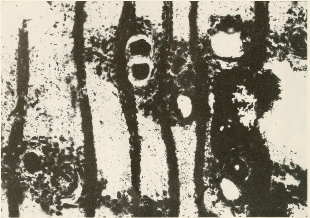
Abb. 5: Querschliff. Dickwandige Gefäße, Parenchym vasizentrisch, schwach aliform, teils confluent. Inventar-Nr. BSP 1971 I 57.  $\times 150$ .
