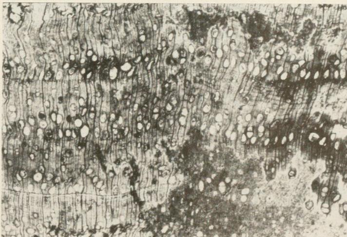
Abb. 1. Querschliff. Halbringporige Gefäßverteilung mit drei Zuwachszonen. 7×.
