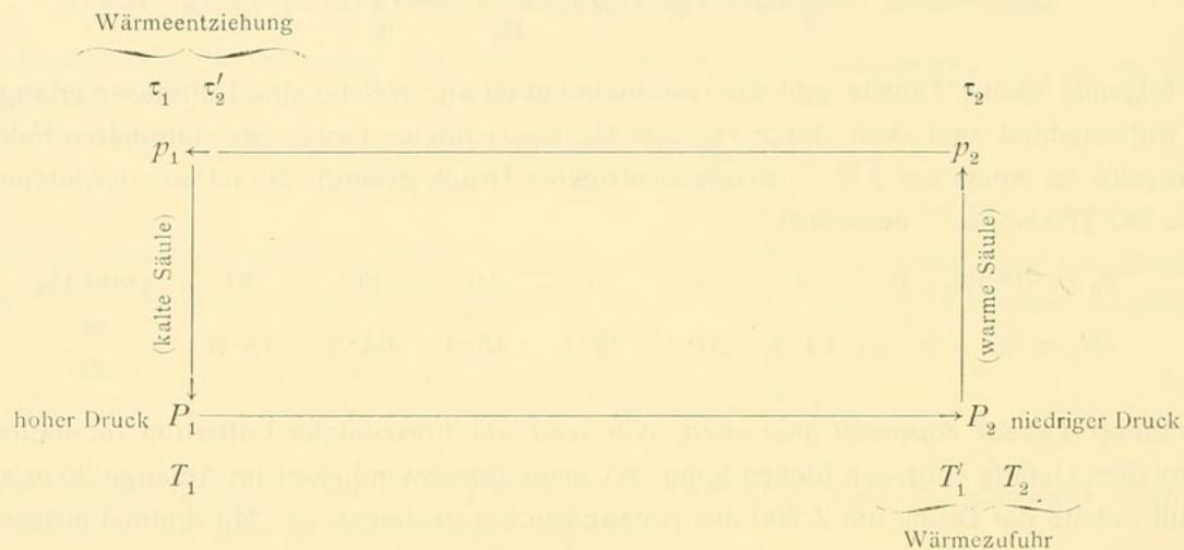
(1) Die Luft fließt unten horizontal vom hohen Druck  $P_1$  zu niedrigem  $P_2$  und nimmt dabei Wärme auf; der Rechnung wegen setzt man statt dessen Zustandsänderung von  $P_1$  zu  $P_2$  adiabatisch, Abkühlung von  $T_1$  zu  $T'_1$ , dann Wärmezufuhr beim Druck  $P_2$ , Temperaturerhöhung von  $T'_1$  zu  $T_2$ .
