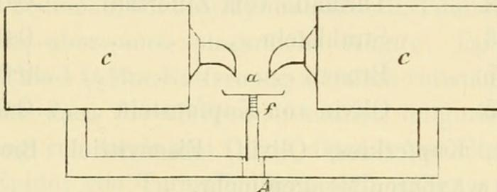
messen, wird ein Messingtischchen in *A* aufgeschraubt, auf welches die Glasplatte gelegt wird, auf der das Pulver gleichmässig ausgestreut wird. Das Tischchen ist verschiebbar, so dass man beliebig die Distanz zwischen den hakenförmig gekrümmten Polen *a* des Elektromagneten und der Glasplatte ändern kann, wobei durch eine am Fusse *f* des Tischchens angebrachte Scala diese Entfernung messbar wird (Stromstärke 6 Elemente).
