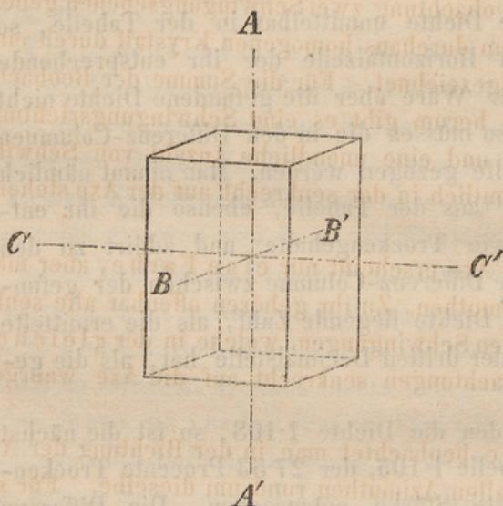
Die Linie  $AA'$  Fig. 1 ist die Axe des Krystalls,  $BB'$  die Längsrichtung, in welcher das Auge den Krystall betrachtet,  $CC'$  die Querrichtung, senkrecht auf den beiden andern.
