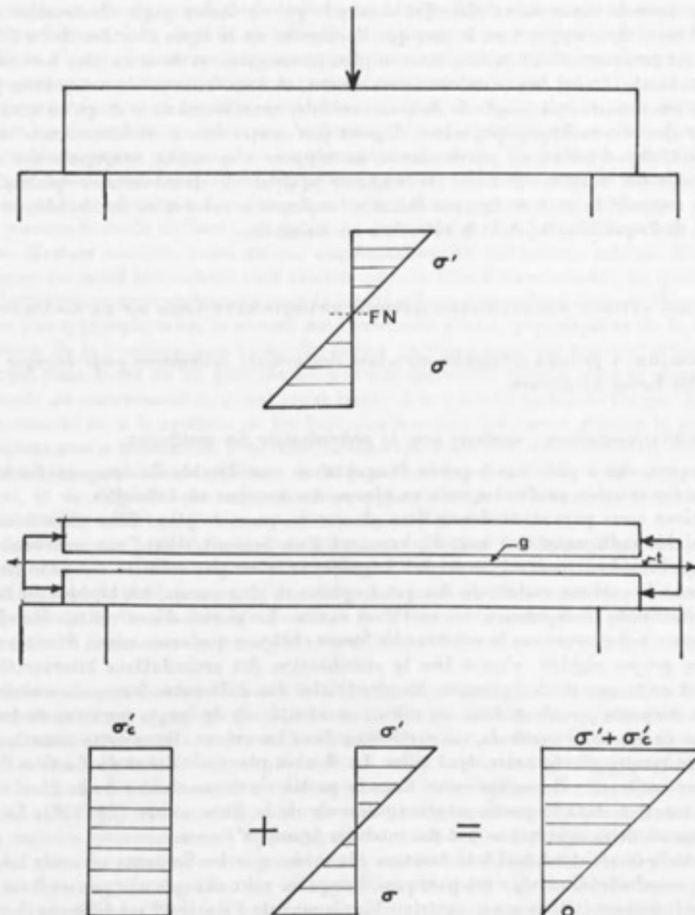
FIG. 136.— Répartition des contraintes de traction ( $\sigma$ ) et de compression ( $\sigma'$ ) dans une poutre posée sur 2 appuis ; en haut, simplement soumise à son poids, en bas, dans le cas d'une poutre en béton soumise en plus à une précontrainte ( $\sigma'c$ ) de compression ; les contraintes de tractions sont alors annulées.
