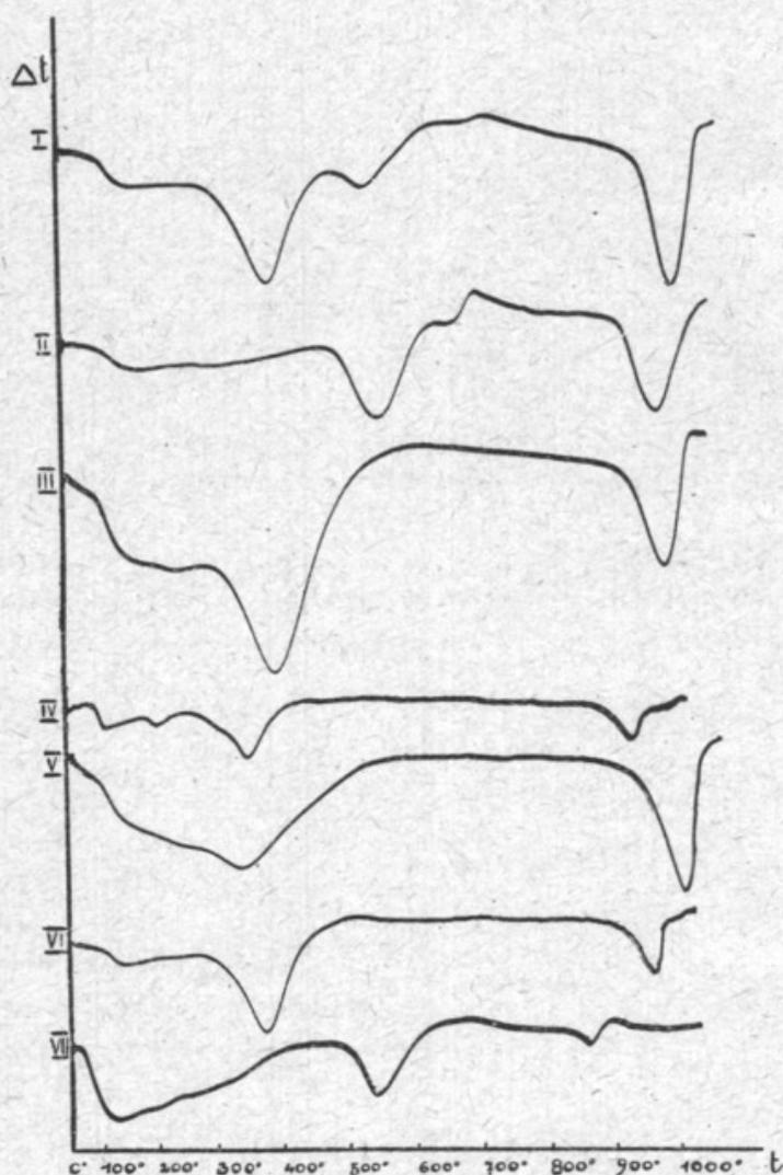
Fig. 1. — Courbes thermiques différentielles. — I. Couche  $l_3$ ; II. Intercalaire  $l_2-l_3$  chloriteux; III. Intercalaire  $l_2-l_3$  ferrugineux; IV et V. Couche  $l_2$ ; VI. Intercalaire  $l_2-l_1$ ; VII. Niveau marneux.
